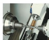
齒輪仿齒加工 PINION SKIVING
